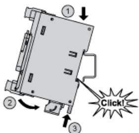
Montaggio diretto sulla superficie di un pannello
