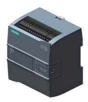
SIMATIC S7-1200, CPU 1212C, CPU compatta, DC/DC/DC, onboard I/O: 8 DI, DC 24 V 6 DO DC 24V; 2 AI DC 0-10V, alimentazione di corrente: DC 20,4-28,8V DC, Memoria programma/dati 75 KB
